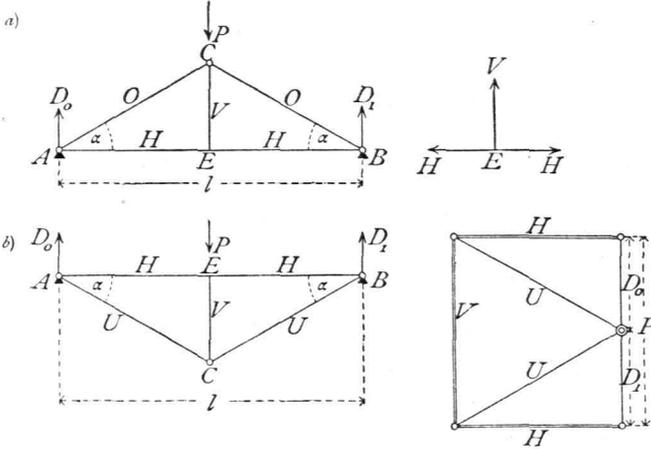
oder in dem Knotenpunkte E des Hängebockes (Fig. 223 a) die Last P wirkt, so wird die Auflager-Reaction
