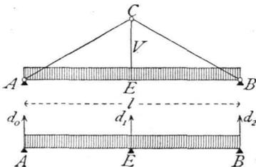
auch die ungünstigste; denn jede Last, wo sie auch liegen möge, erzeugt in A und B (Fig. 224) Auflager-Reactionen, also in den Stäben der oberen Gurtung Druck, in denen der unteren Gurtung Zug. Bei dieser Belastung ist AEB wie ein continuirlicher Balken auf 3 Stützen A, E und B aufzufassen; die Mittelfstütze wird durch die Hängefäule CE gebildet. In derselben entsteht demnach ein Zug, welcher nach dem Principe von Wirkung
