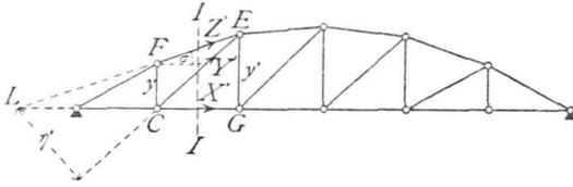
Wenn die obere Gurtung gekrümmt ist (Fig. 207), wird für den Stab  $FE$ , wenn alle Bezeichnungen die obige Bedeutung behalten,
