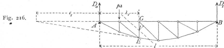
Die Maximalspannungen in den Verticalen ergeben sich mit
