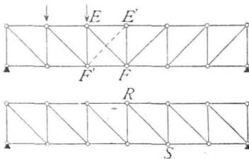
genau so zu ermitteln, als wären die Hauptdiagonalen nicht vorhanden; jede Gegendiagonale, z. B. etwa  $E'F'$ , befindet sich genau in derselben Lage, wie die symmetrisch zur Trägermitte liegende Hauptdiagonale in dem Träger mit nur nach einer Seite
