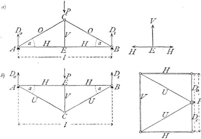
oder in dem Knotenpunkte E des Hängebockes (Fig. 223 a) die Last P wirkt, so wird die Auflager-Reaction  $D_0 = D_1 = \frac{P}{2}$ . Die im Punkte A wirkenden 3 Kräfte  $D_0$ ,  $O$  und  $H$  halten einander im Gleichgewicht, und es sind demnach die algebraischen Summen der in diesem Knotenpunkte wirkenden Horizontalcomponenten, bezw. Verticalcomponenten je gleich Null, d. h. es ist
