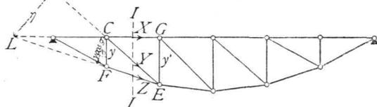
$$O = M - Z y \cos \sigma, \quad \text{woraus} \quad Z = \frac{M}{y \cos \sigma} \quad \dots \quad 229.$$
