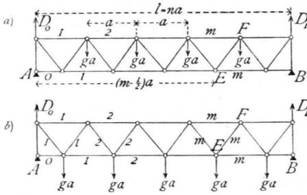
ist mit  $ga$  belastet; die Belastungen der Knotenpunkte über den Auflagern berücksichtigen wir nicht, weil diese direct vom Auflager aufgenommen werden.
