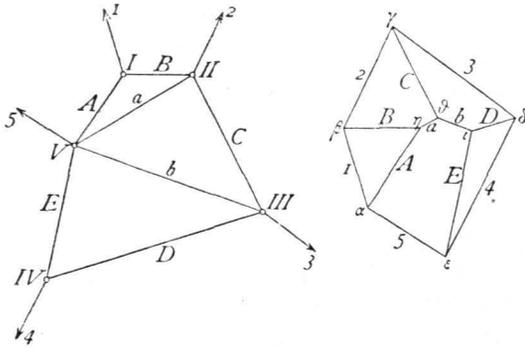
Kräfte nach Größe und Richtung gegeben sind, leicht construirt werden kann. Außerdem sind an jedem Knotenpunkte die an demselben wirkenden Kräfte für sich im Gleichgewicht; es ist also für jeden dieser Knotenpunkte ein kleines secundäres, sich schließendes Kraftpolygon möglich. An jedem Knotenpunkte wirken: eine äußere Kraft, die im speciellen Falle Null sein kann, und die Spannungen der Stäbe, welche sich in ihm schneiden, also im Knotenpunkte  $II$  die Kräfte  $2, B, C, a$ .
