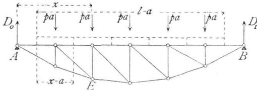
Für irgend einen Knotenpunkt  $E$  (Fig. 211) ist auch das Moment in beiden Fällen gleich, wenn nur die Belaftung von der Mitte des dem Auflager zunächst liegenden Feldes bis zur Mitte desjenigen Feldes gerechnet wird, welches  $E$  vorhergeht.
