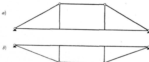
Gurtung zeigt eine gerade, die andere eine gebrochene Linie. Ist die untere Gurtung gerade, so erhält man die unter dem Namen des einfachen, bezw. doppelten Hängebockes bekannte Trägerform (Fig. 221 a, bezw. 222 a) — nicht zu verwechseln mit den Hängewerkträgern, welche nach Art. 357, S. 315 von der hier betrachteten wesentlich verschieden sind. Ist die obere Gurtung gerade, so erhält man die unter dem Namen des armirten Balkens bekannte Trägeranordnung (Fig. 221 b u. 222 b).
