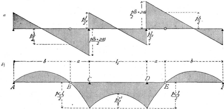
Der erste Theil des Momentes ist das Moment für einen frei aufliegenden Balken von der Stützweite  $l_1$ ; der zweite Theil ist das Moment über der Stütze  $C$ , bezw.  $D$ .
