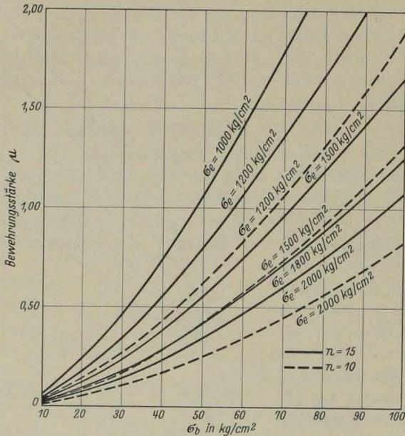
Abb. 16. Beziehungen zwischen  $\sigma_b$ ,  $\sigma_e$  und  $\mu$  bei biegebeanspruchten Rechteckquerschnitten.
