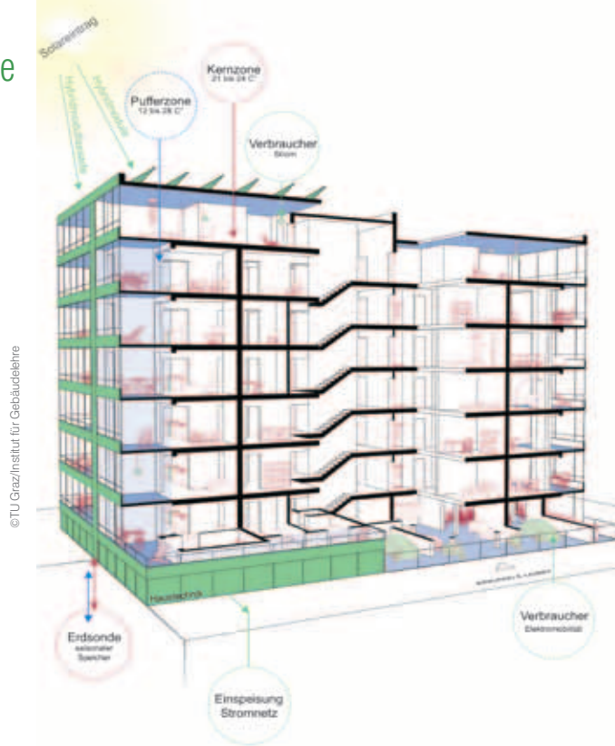
Abbildung. 4: Axonometrischer Schnitt Haustechnik.
