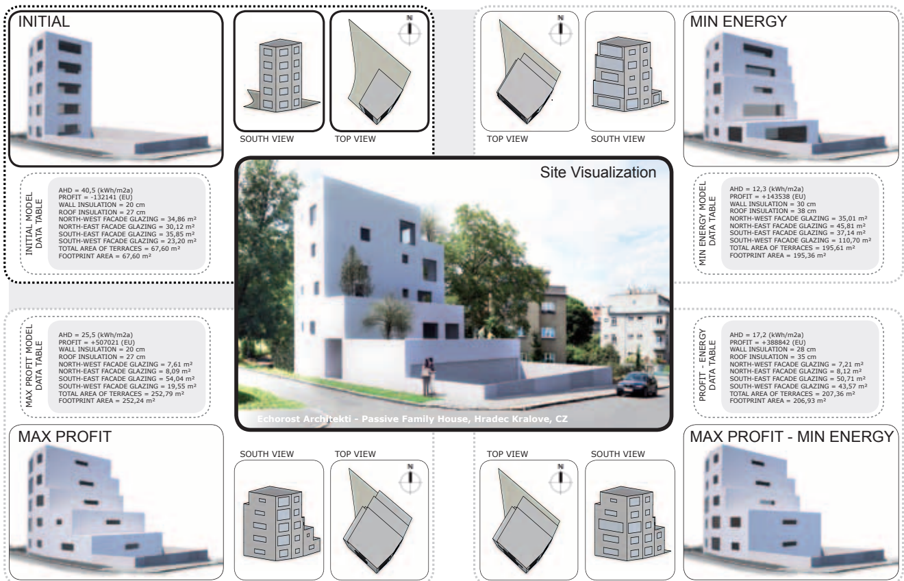
Abbildung 2: Performative Optimierungen der Gebäudehülle eines Wohnhauses basierend auf thermischen und ökonomischen Simulationen.
