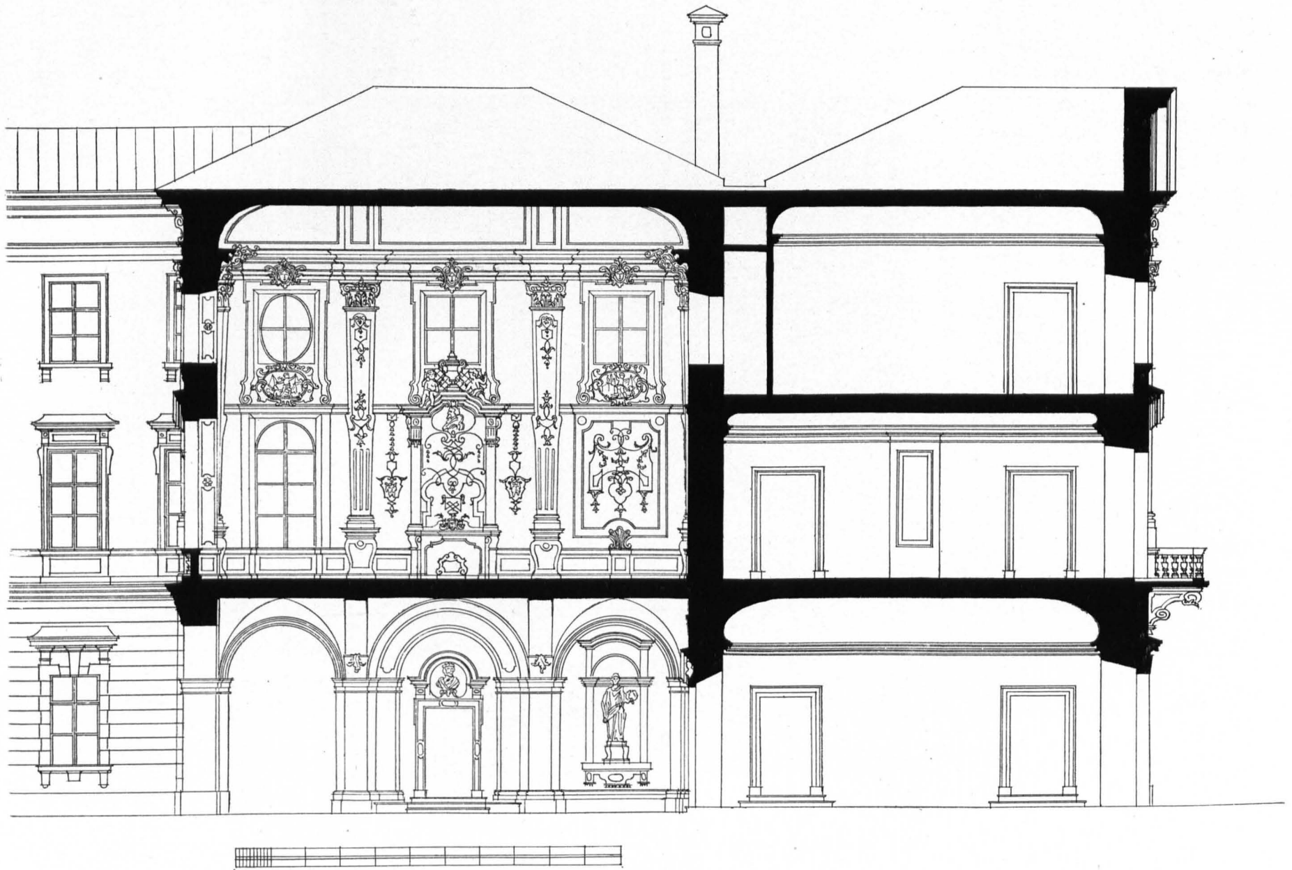
Fig. 246 Mirabell, Schnitt durch den Gartentrakt, 1 : 150 (S. 192)
