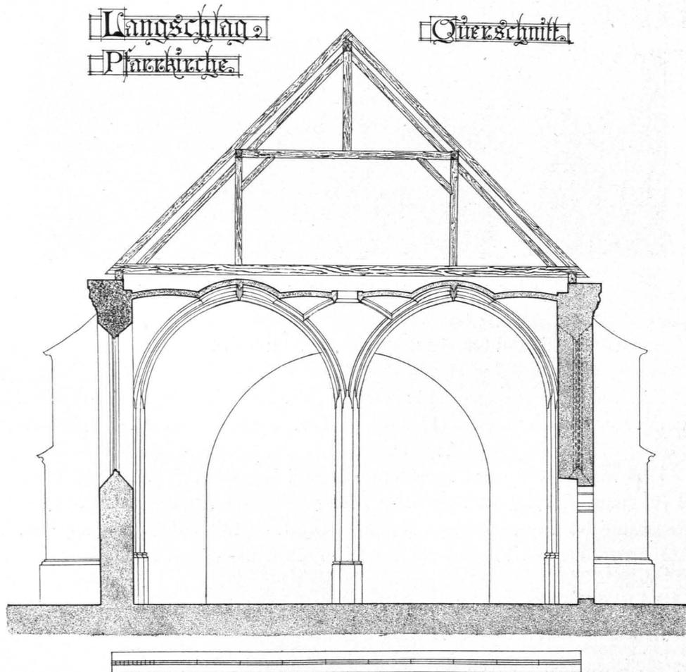
Fig. 217 Langschlag, Pfarrkirche, Querschnitt durch das Langhaus, 1 : 125 (S. 248)
