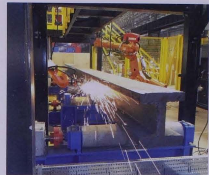
AUSSCHLEIFEN VON EINSCHLÜSSEN IN I-TRÄGERN, QUELLE: ABB AG
