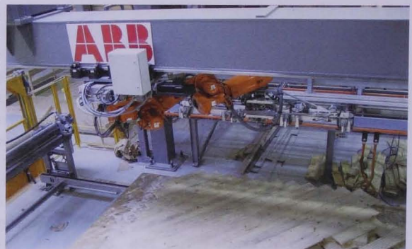
ROBOTERLEGEANLAGE FÜR HOLZELEMENTE, QUELLE: ABB AG
