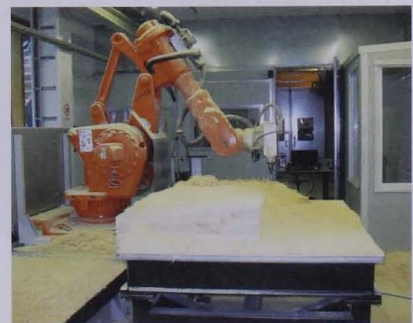
ROBOTERFRÄSEN GUSSFORMEN: BRETTSPERRHOLZ FORMENBAU, QUELLE: TU GRAZ
