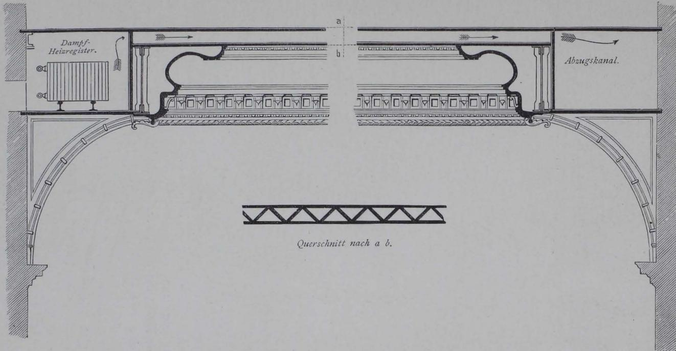
Ueber den Heizregistern einzelne aufzunehmende Fussboden-Platten. — Die unteren Dreikante im Fussboden sind an beiden Enden des Systems geschlossen, nur die oberen Züge werden von der heissen Luft durchströmt.
