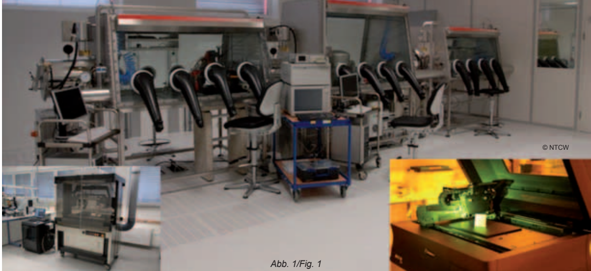
Abb. 1: Modulare Pilot- und Demonstrationsanlage mit Glove-Box-Cluster für Dünnschicht im ISO-zertifizierten Reinraum der NTCW sowie industrielle 2-D- und 3-D-Inkjet-Druck-Systeme.
