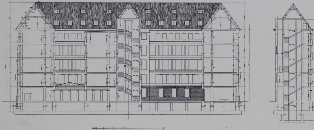
Abb. 206. Verwaltungsgebäude der Mannesmannröhren-Werke in Düsseldorf. 1911 bis 1912. Längsschnitt von Norden nach Süden. Querschnitt von Osten nach Westen durch die Stockwerkstreppe in der Südostecke des Hinterflügels
