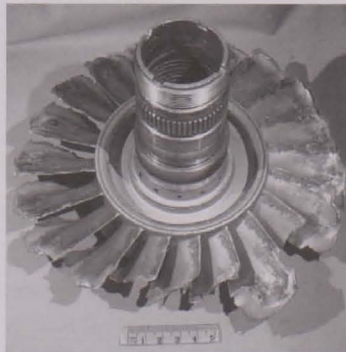
Abbildung 1 Schaden an einem Verdichterrotor infolge eines Dauerschwingbruches
