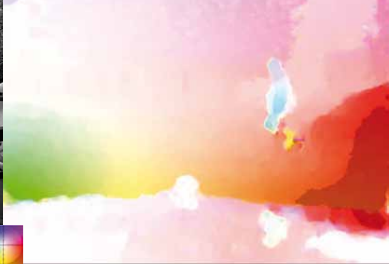
Abb. 1: Bewegungsschätzung aus Bildsequenzen (Kooperation mit Daimler AG). Die Abbildung zeigt links ein Eingabebild und rechts das geschätzte Bewegungsfeld, welches zur besseren Visualisierung farbkodiert wurde (siehe Farbcode). Durch den entwickelten Algorithmus kann die Bewegungsschätzung in Echtzeit erfolgen und somit in Fahrerassistenzsystemen zur Gefahrenerkennung eingesetzt werden 2 (siehe auch ► www.6d-vision.de ).
