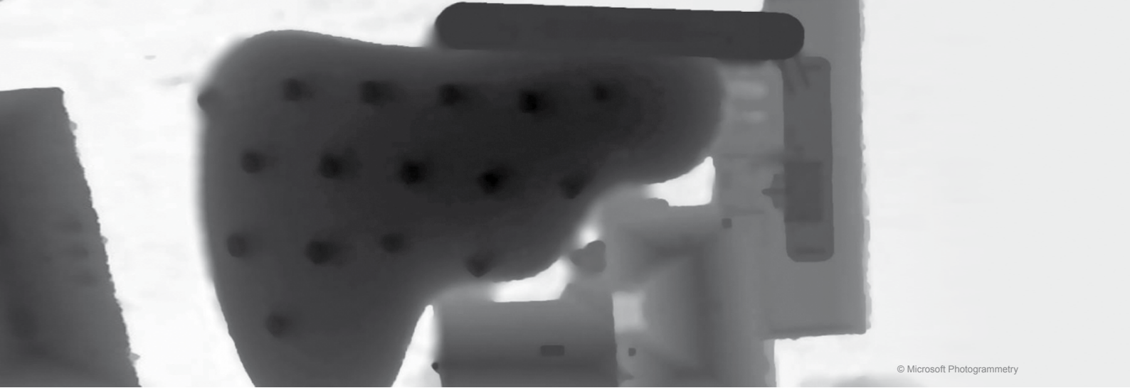
Abb. 2: Stereo aus multiplen Ansichten (Kooperation mit Microsoft Photogrammetry). Die Abbildung zeigt oben die Tiefenkarte (je heller der Grauwert, desto tiefer) und unten eine Visualisierung des finalen 3-D-Modells. Der entwickelte primal-duale Algorithmus erlaubt eine effiziente und global optimale Lösung von schwierigen Stereoproblemen wie der hier gezeigten 3-D-Rekonstruktion des Grazer Kunsthauses 3 .
