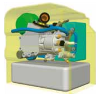
Abb. 1: Einbaustudie für einen Hybrid Scooter mit Range Extender 4 .
