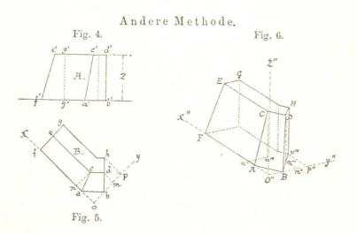
Die Figuren A und B seien Aufriss und Grundriss eines Schnittsteines. Wir umschreiben demselben ein rechtwinkliges Parallelepiped (resp. den Quader, aus welchem der betreffende Stein gemacht werden kann); die Länge desselben ist Of, die Breite Op, also fOpg die Grundfläche des Quaders, seine Höhe ist gleich der Höhe des Steines im Aufriss b'd'=z.
