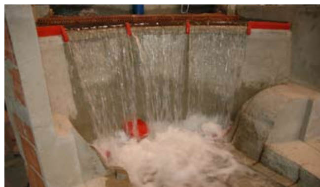
Modell Hochwasserentlastung – Tosbecken
