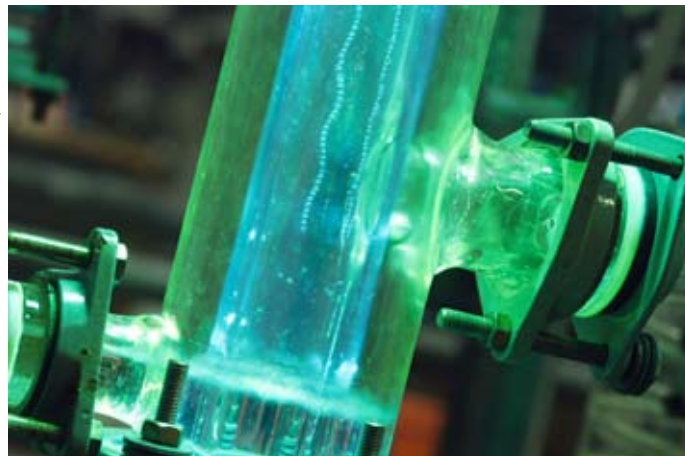
Boden der Fallfilmkolonne im Filmbetrieb bei UV-Bestrahlung
