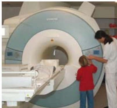
Abb. 1. 3T MR-System, Siemens Tim Trio. Gewicht: 13 Tonnen, Innere Tunnellänge: 142 cm, Gesamtlänge des Tunnels: 213 cm, Durchmesser des Tunnels: 60 cm, Gradientenstärke: 40 mT/m, HF Pulsleistung 25kW, 18 parallel digitale Empfangskanäle für „Parallele Bildgebung“
