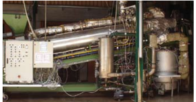
Abb. 2 Versuchsanlage Gestufte Vergasung - IWT (60 kWel)
