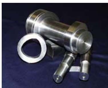
Forschungsschwerpunkt CNC-Unrundschleifen: Bearbeitungsbeispiele: Polygonnabe P3G, Polygonwellen P3G und P4C und Nockenwelle
