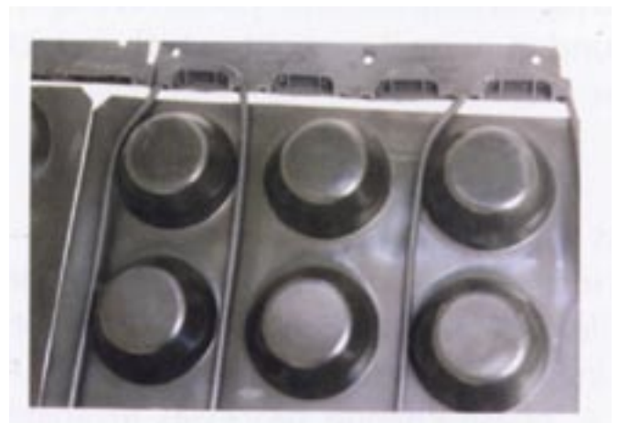
Phase changing material (PCM) zur Anpassung der Speicherfähigkeit von Materialien Bild: Michelle Addington, Smart Materials and Technologies for the architecture and design professions, Elsevier Architectural Press, Oxford 2005
