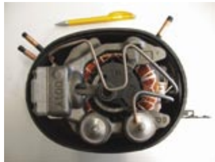
Innenleben eines hermetischen Kältemittel - Kolbenkompressor von ACC (Bild: ACC, CDL)
