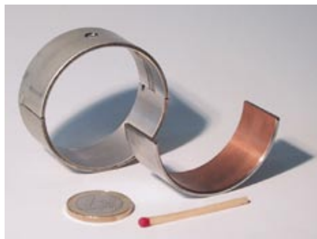
Typische Gleitlager für Hubkolbenmotoren (Bild: Robert Bauer)
