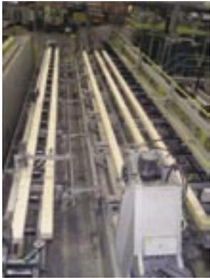
In den Produktionsprozess integrierte ‚proof loading‘-Anlage
