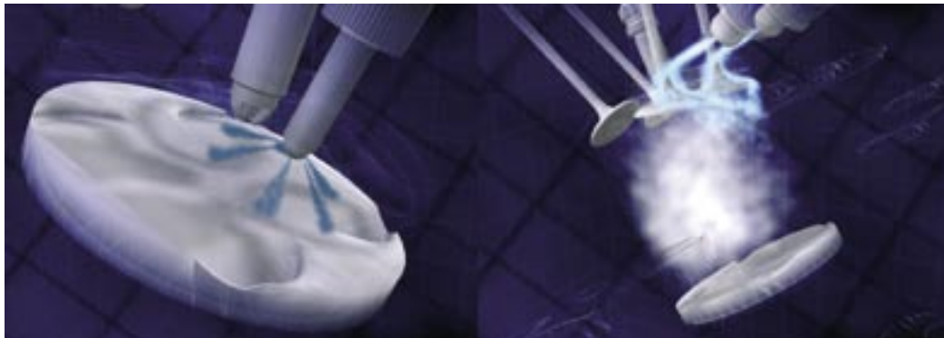
Hochdruckeinblasung und kryogene Gemischbildung (Quelle: BMW)
