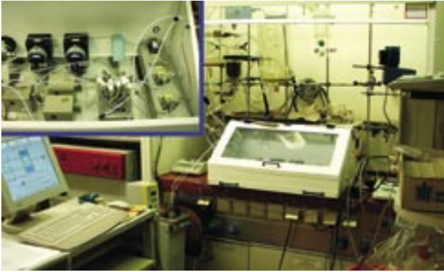
Mikroanlage für die Durchführung von Flüssig-Flüssig-Extraktionsprozessen am Institut für Thermische Verfahrenstechnik und Umwelttechnik.
