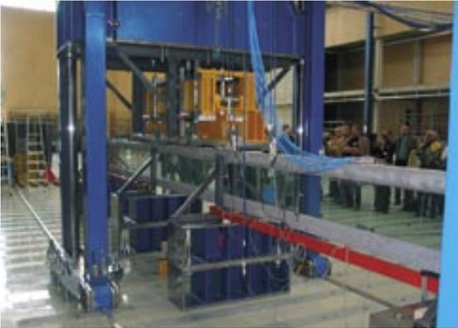
Versuch eines Glas-Beton Verbundträgers
