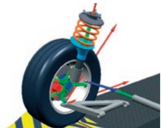
Abb. 2: MKS-Simulationsmodell einer PKW-Einzelradaufhängung, Bildquelle: MSC Software GmbH
