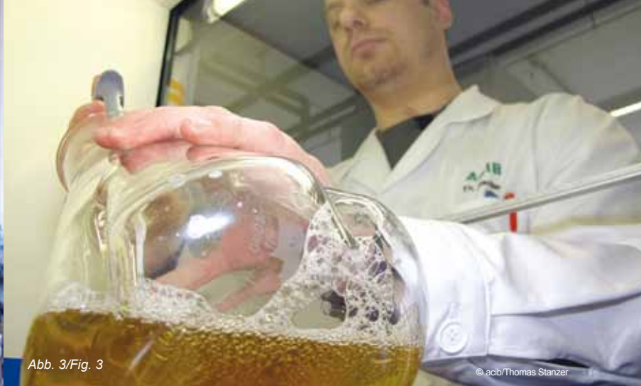
Abb. 3: Schüttelkolben für die Produktion rekombinanter humaner Enzyme.
