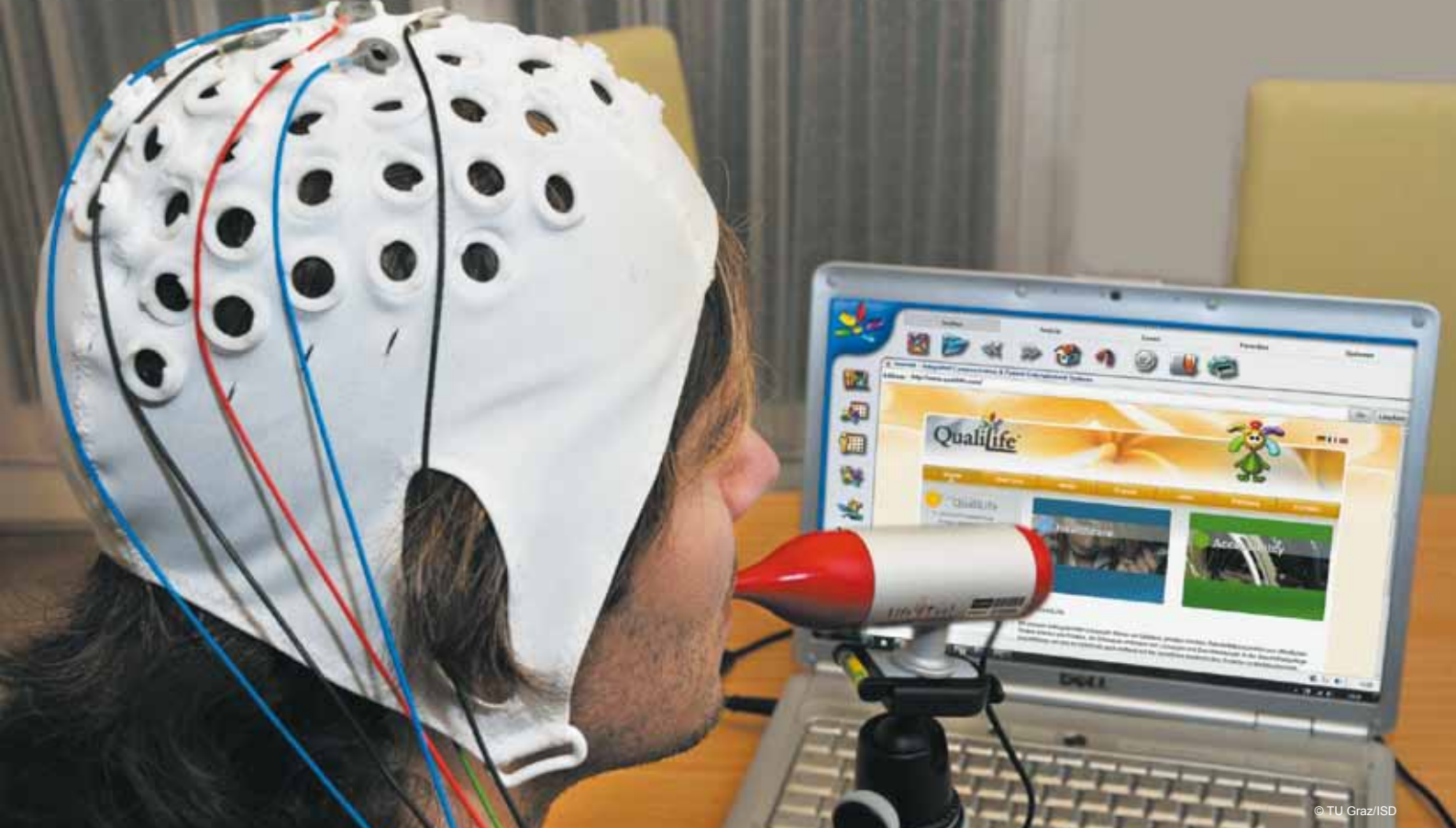
Abb. 3: hBCI-Benutzer mit Mundmaus und BCI zur Softwarebedienung.
