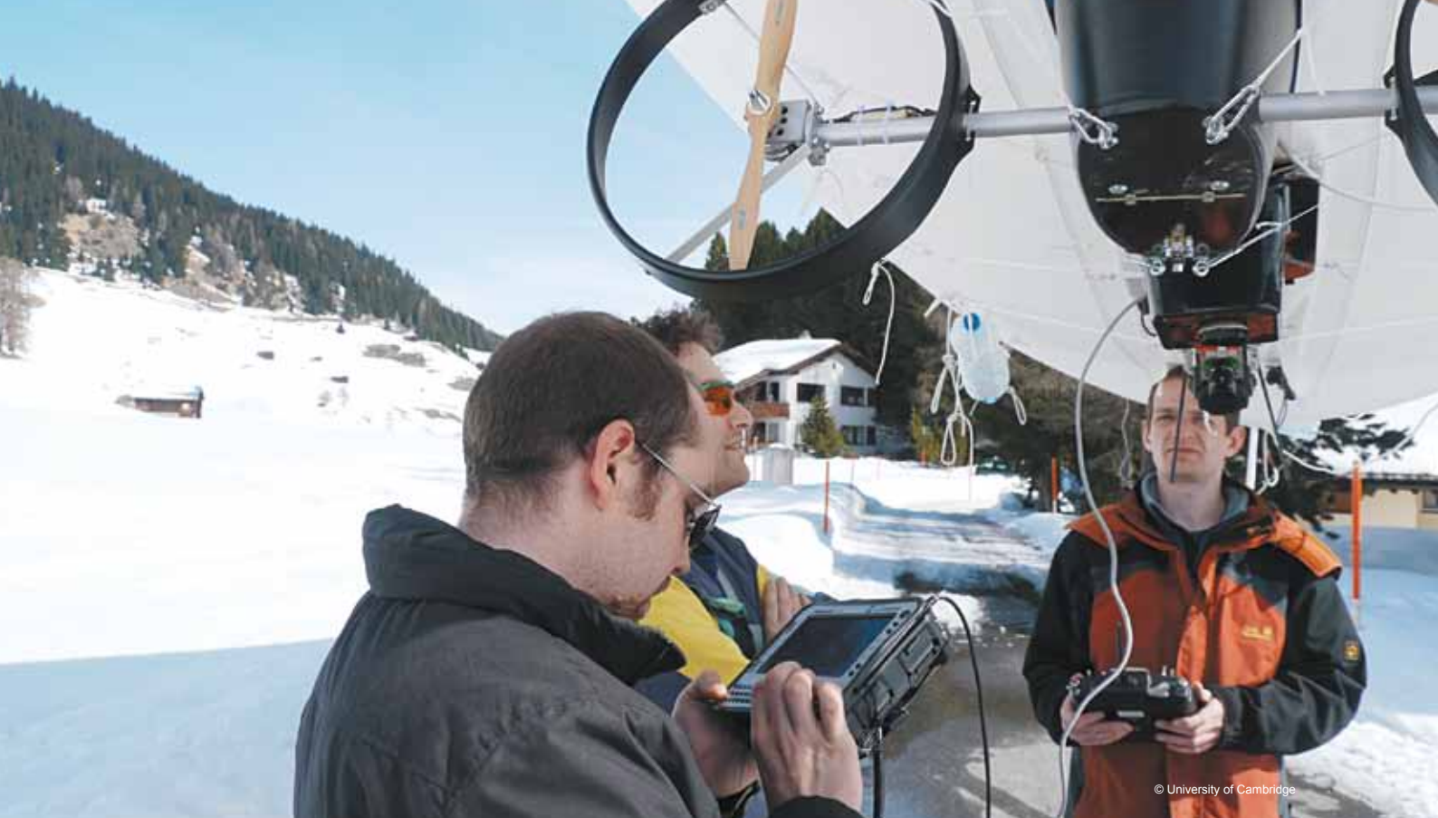
Abb. 1: Unbemannte Fluggeräte-plattform für die Verfeinerung von Geländemodellen und die Generierung thermischer Daten.
