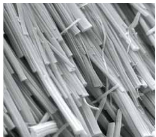
Abb. 3: Rasterelektronenmikroskopie von Thaumasitnadelchen (10.000-fache Vergrößerung).
