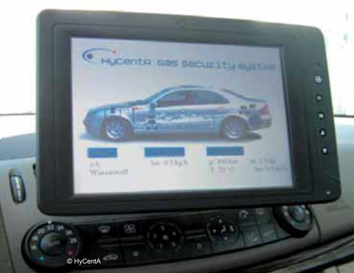
Abb.: Touchscreen und Hauptmenü, Fig.: Touchscreen with Main Menu
