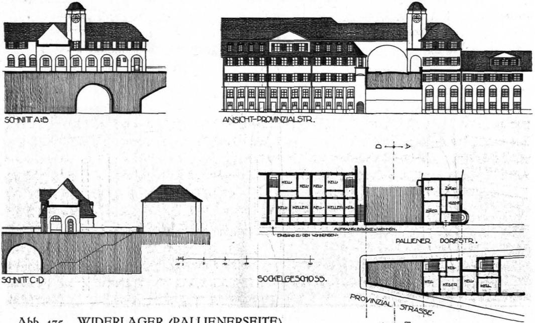
Abb. 175. WIDERLAGER (PALLIENERSEITE).
