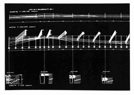
Wenn die Straßenachse in Grundund Aufriß festgelegt ist, bringt eine automatische Auswertung des Digitalen Geländemodells alle Daten für Längenschnitt und Querprofile. Anschließend wird das Regelprofil spezifiziert (Bankettbreiten, Böschungsneigungen usw.) und das Programm zeichnet die Querprofile und führt die Massenermittlung durch.
