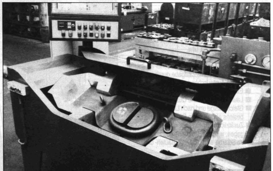
**Abb. 7:** Vollautomatische Kalibrier-, Prüf- und Meßmaschine für Zubehörteile
