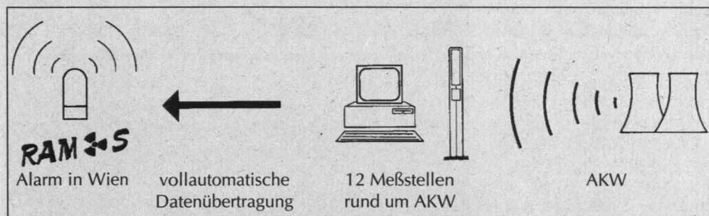
Um jedes AKW sollen bis zu 12 RAMOS-Meßeinheiten installiert werden, die täglich die Meßdaten in die jeweilige Länderzentrale und nach Wien senden. Stellen sie eine Grenzwertüberschreitung fest, alarmieren sie vollautomatisch RAMOS Zentrale bei GLOBAL 2000.
