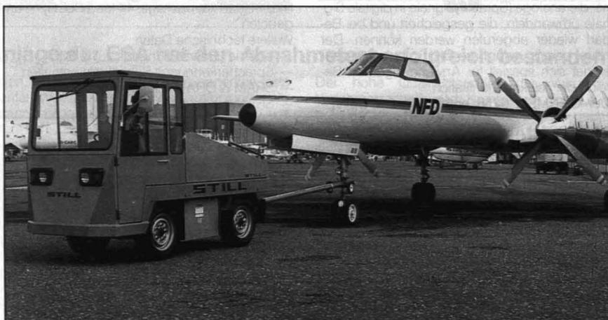
durch den dieselelektrischen Antrieb des Schleppers verhältnismäßig einfach: Ein Golf-Diesel-Motor mit einer Leistung von 25 kW treibt einen Generator, der den erzeugten Strom über eine Elektronik geregelt an den elektrischen Fahrmotor weitergibt. Dazu kam nur eine Antriebsbatterie, die mit 220 Amperestunden etwa halb so groß ist, wie die Batterie eines normalen Elektro-Schleppers. Ein Schlepper benötigt die meiste Energie beim
