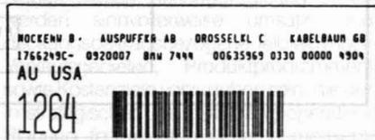
Abb. 8: Motorauftrag (Barcodeaufkleber)
