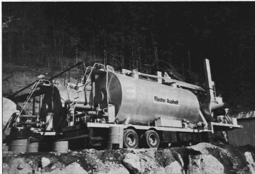
Abb. 4: Herstellung von Drainasphalt-Mischgut in konventionellen Asphaltmischanlagen
