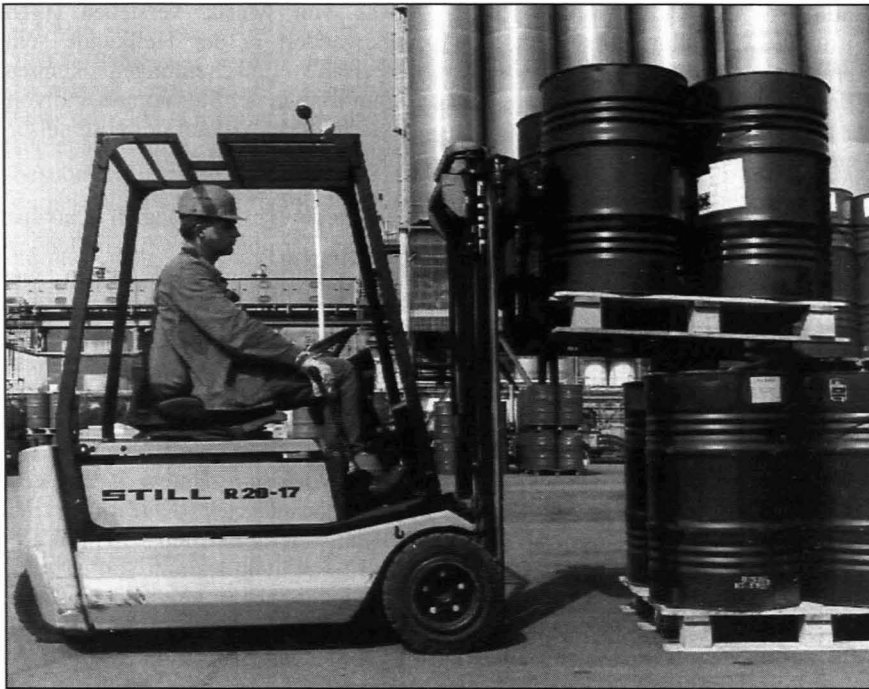
Die Akzeptanz der Baureihe R am Markt beweist die kalkulierbare Wirtschaftlichkeit dieser neuen Elektro-Dreirad-Gabelstapler mit Zwei-Motoren- Vorderradantrieb.
