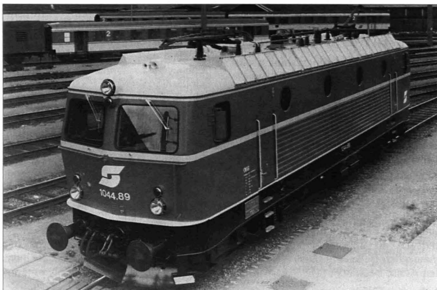
Abb. 2: 4-achsige (Thyristor)-Lokomotive der ÖBB mit Mischstrom-Fahrmotoren
