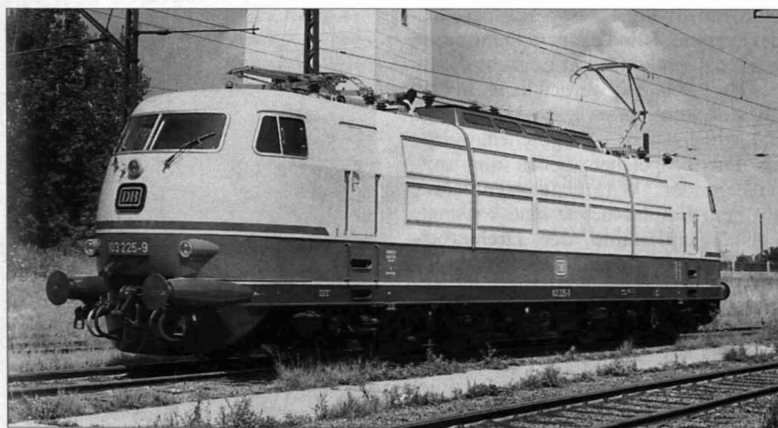
Abb. 1: 6-achsige Lokomotive der DB mit Wechselstrom-Fahrmotoren
