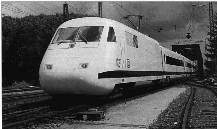
Abb. 3: Intercity-Expres der DB, Triebfahrzeug mit asynchronen Fahrmotoren
