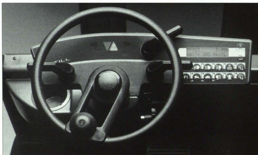
DAΣ ÜBERSICHTLICHE COCKPIT. AM DISPLAY ALLE DATEN ZUM AKTUELLEN BETRIEBSZUSTAND; MIT DEN TASTEN „HASE“ UND „SCHILDKRÖTE“ LASSEN SICH VORPROGRAMMIERTE FAHRPROGRAMME ABRUFEN.
