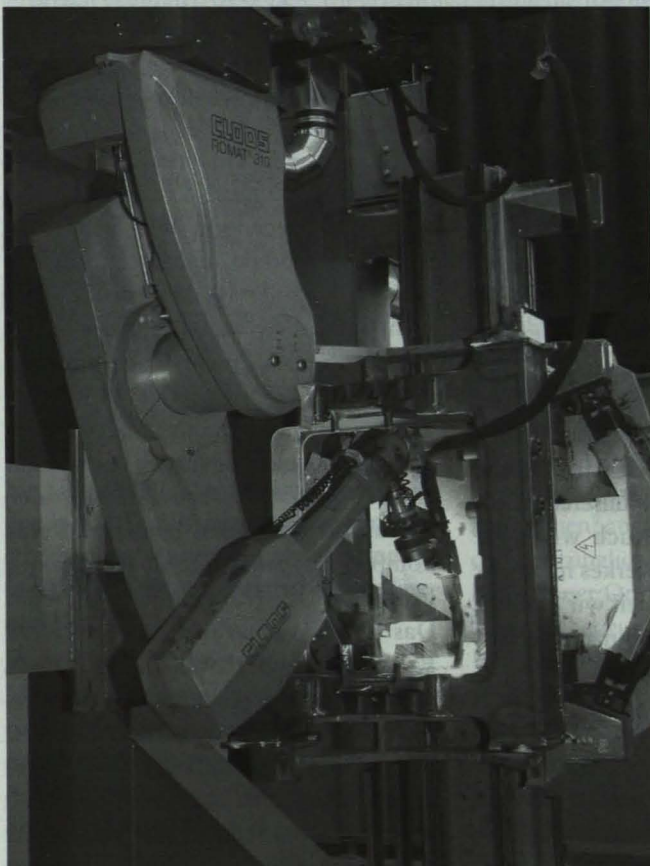
Abb. 3: Automatisierung durch Schweissroboter
