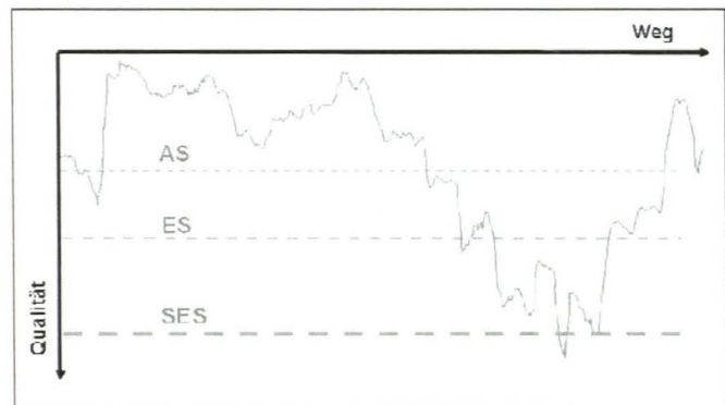
Abb. 1. Isolierte Betrachtung von Messfahrten (Qualitäts-Weg-Diagramm) unter Berücksichtigung der Eingriffsschwellen (AS, ES, SES)
