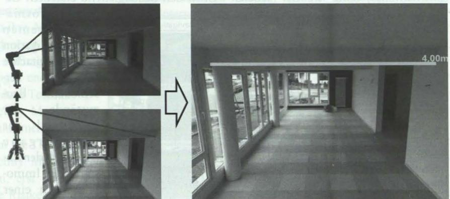
ABB. 5: PHOTOGRAMMETRISCHE STRECKENMESSUNG IN VOLLSPHÄRISCHEN FOTOGRAFIEN
