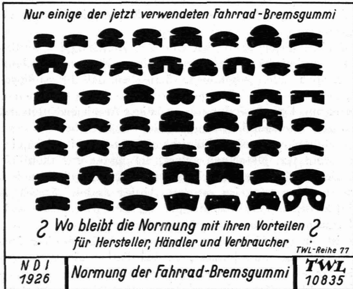
Abb. 169. Ein Beispiel aus dem Jahre 1926 für die Aufgaben der Normung (Abdruck eines Diapositives der Technisch-Wissenschaftlichen Lehrmittelzentrale, Berlin NW 7). Bremsgummi, jetzt genormt nach DIN FAF 24.
