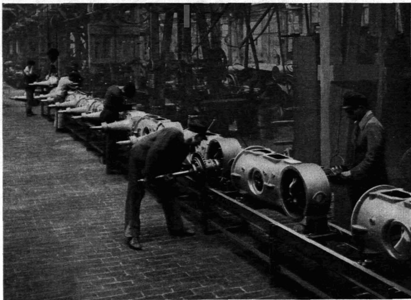
Abb. 156. Zusammenbau von Getriebegehäusen für Motorschlepper in Fließarbeit bei der Hanomag, Hannover (TWL 4683).
